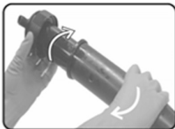
Fig. 15 – Liberando a câmara de compressão do cilindro
